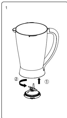
Установите нож в сборе в чашу блендера (снизу вверх, как показано на рисунке) и закрутите его против часовой стрелки. Для извлечения поверните нож в обратном направлении.
